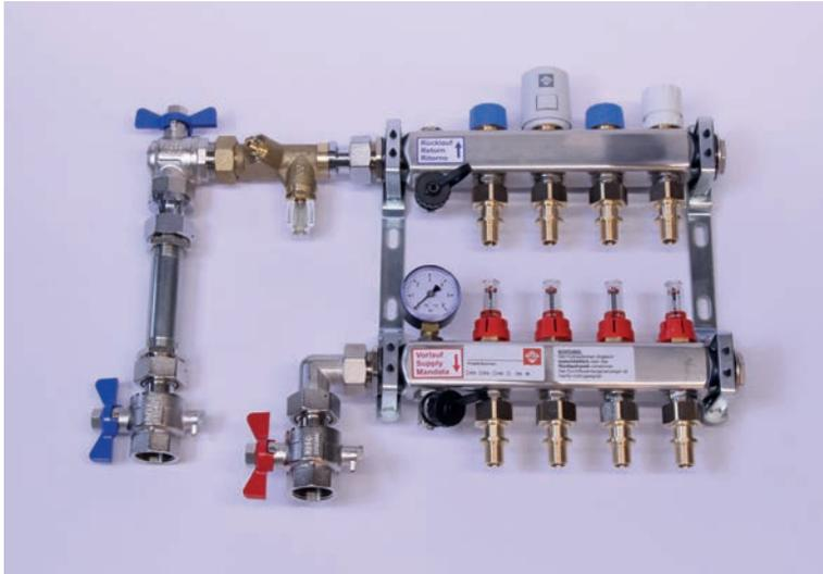
Edelstahl-Heizkreisverteiler mit Wärmezählermessstrecke samt kombiniertem Passtück 3/4" und 1" und zusätzlichem Eck-Kugelhahn im Rücklauf, Strangregulierventil sowie 2 Kugelhähnen in 1".
