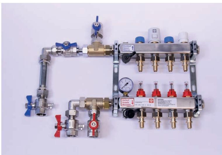
Edelstahl-Heizkreisverteiler mit Wärmezählermessstrecke samt kombiniertem Passstück 3/4" und 1" und zusätzlichem Kugelhahn im Rücklauf. Mit 2 Kugelhähnen in 1" sowie zusätzlichem T-Stück 1" mit Kugelhahn 1".
