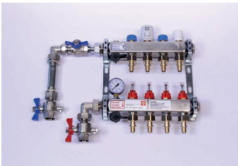
Edelstahl-Heizkreisverteiler mit Wärmezählermessstrecke samt kombiniertem Passstück 3/4" und 1", zusätzlichem Kugelhahn im Rücklauf und mit 2 Kugelhähnen in 1".
