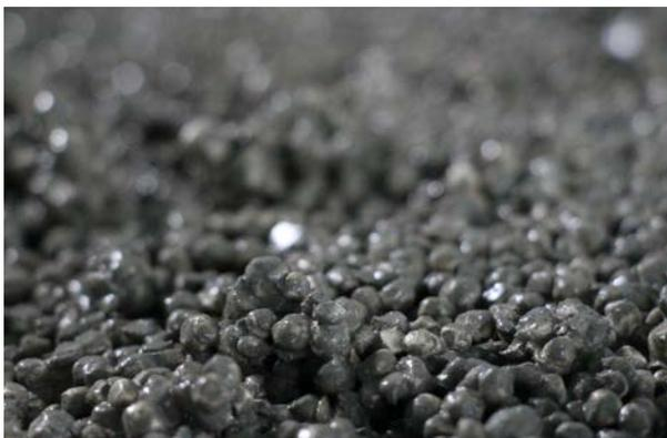
Unsere fest gebundene Schüttung besteht aus wiederverwendetem Polystyrol von unseren Bauvorhaben und Zement. Bei der Trocknung entsteht eine feste Verbindung.
